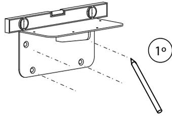
Verwenden Sie das Wasserwaage-Werkzeug. Markieren Sie die Löcher mit einem Bleistift.
