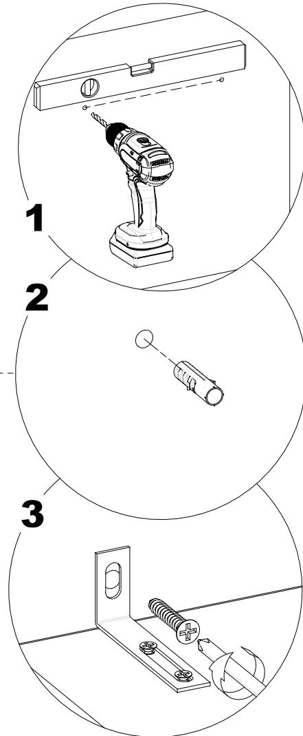
**BE AANDACHT!** Het product moet permanent aan de muur worden bevestigd. Bij gebruik van punten kan een gebrek aan bevestiging leiden tot omvallen.
