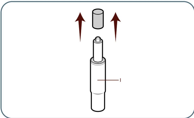
Stecken Sie dann die Gasdruckfeder (**Teil I**) mit der Chromrosette in das mittlere Loch der Basis.
